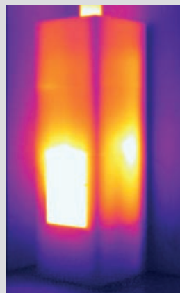
3 hod. od zatopení Průměrná teplota povrchu 88 °C
